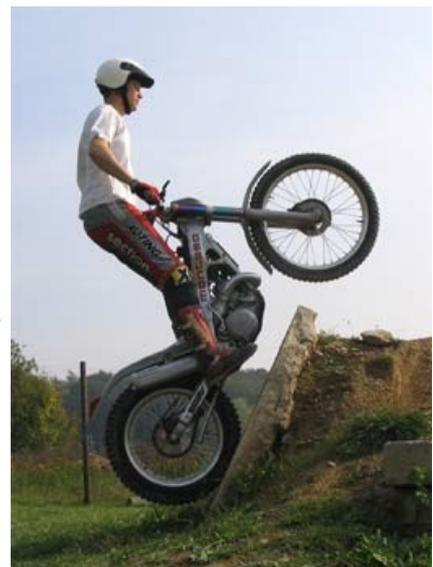
Während man das Vorderrad gegen das Hindernis setzt, verlagert man das Gewicht nach vorne, um die Vorderradfeder einzufedern. Dabei muss der Oberkörper weit nach vorne, Hüfte am Lenker, Schultern vor dem Lenker, Arme angewinkelt. Nun kommt der zweite Gasstoss. Mit diesem zweiten Gasstoss hebt man das Vorderrad so, dass das Hinterrad unten gegen die Absprungkante läuft. (Zeitpunkt siehe Bild)
